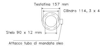
**POSIZIONE STELO CON CABINA A LIVELLO DEL PIANO PIU' BASSO (Attacco Valvola in basso)**
