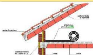
La fase consiste nella stesura dei pannelli isolanti, previo eventuale taglio, su pareti, pavimenti, coperture piane o inclinate, per ancoraggio alle strutture sottostanti, con sigillatura delle giunzioni a mezzo di rete e collante specifico.
