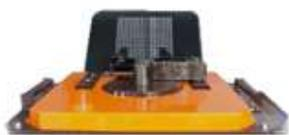
La macchina piegaferri svolge la funzione di piegatura di barre di acciaio al fine di realizzare staffe e sagomati per il cemento armato.
