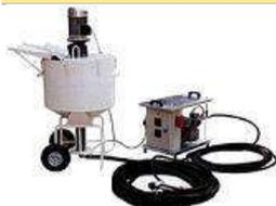
Macchina che proietta malta fluida di cemento sotto pressione per formare intonaci, getti per rivestimento di pareti, ecc...
