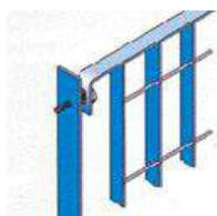
Montaggio delle ringhiere metalliche dei balconi, pre-assemblate in stabilimento. I moduli costituenti le ringhiere metalliche saranno saldati ai predisposti elementi ancorati alle solette dei balconi.
