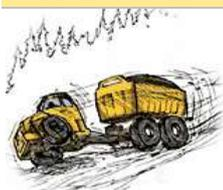
**Situazioni di pericolo:** Nella conduzione di automezzi di cantiere in genere o nel sollevamento meccanico di carichi, si può verificare il ribaltamento del mezzo con il rischio di schiacciamento di persone estranee o dello stesso operatore.
