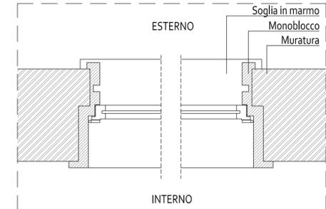
SEZIONE ORIZZONTALE INFISSO ESISTENTE A BATTENTE
