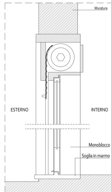
SEZIONE VERTICALE INFISSO ESISTENTE A BATTENTE
